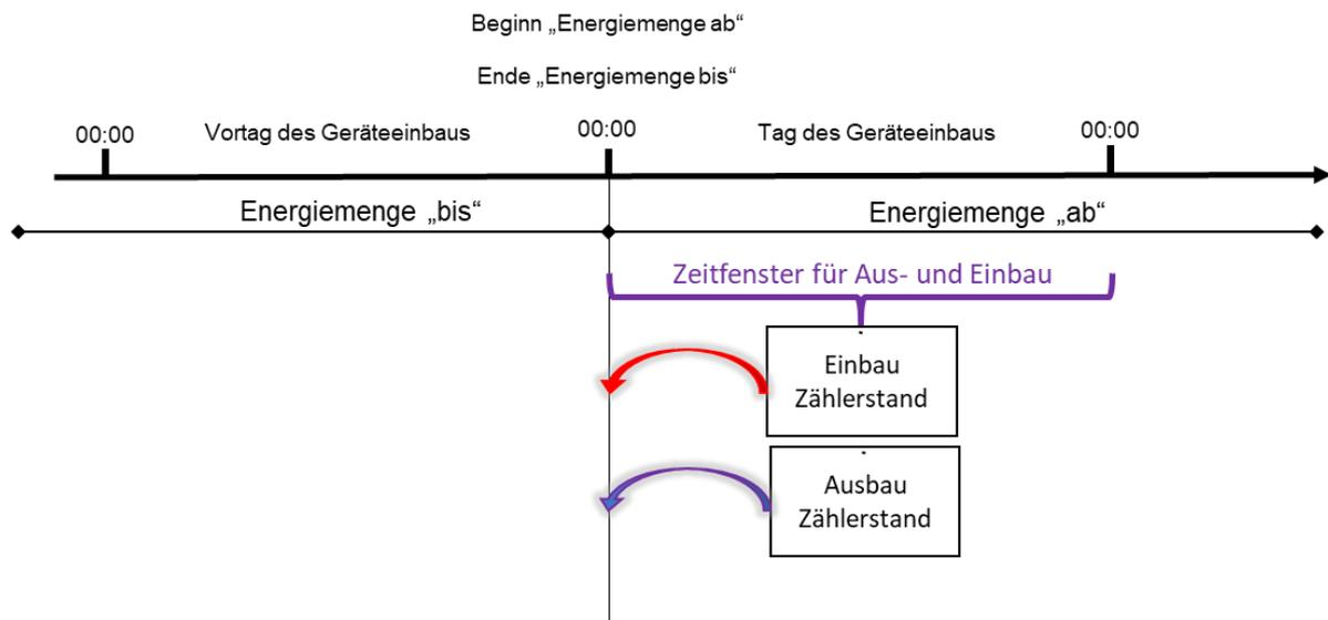
Bild 2: Geräteeinbau und Geräteausbau am selben Tag
